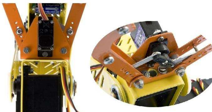
Rys. 32 Poprawne zamontowanie chwytak do ramienia 3.
