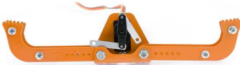
Rys. 30 Pozycjonowanie ośki serwa.
