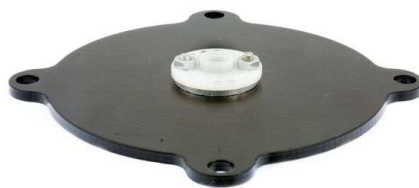
Rys. 7 Płyta dolna z przykręconym orczykiem.
