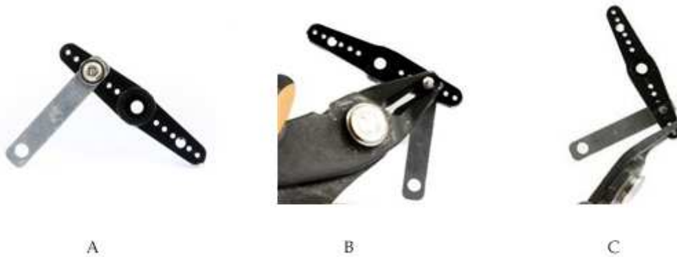
Rys. 28 Montaż ramienia łapki z orczykiem.
