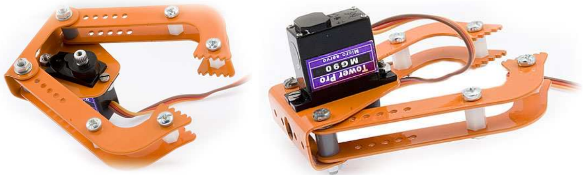
Rys. 27 Zamocowanie serwa MG 90.
