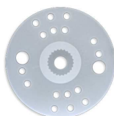
Rys. 6 Poprawne rozwiertenie otworów.
