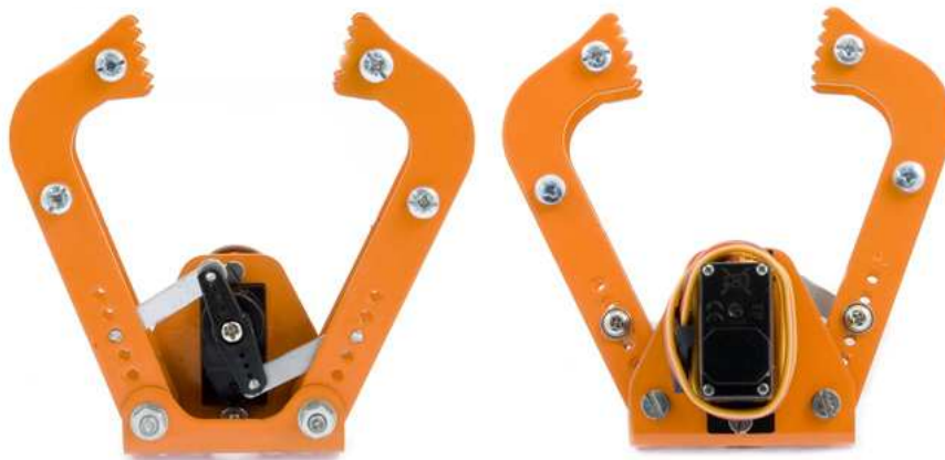
Rys. 31 Poprawnie zmontowany chwytak.
