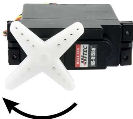
Rys. 15 Pozycjonowanie ośki serwa.
