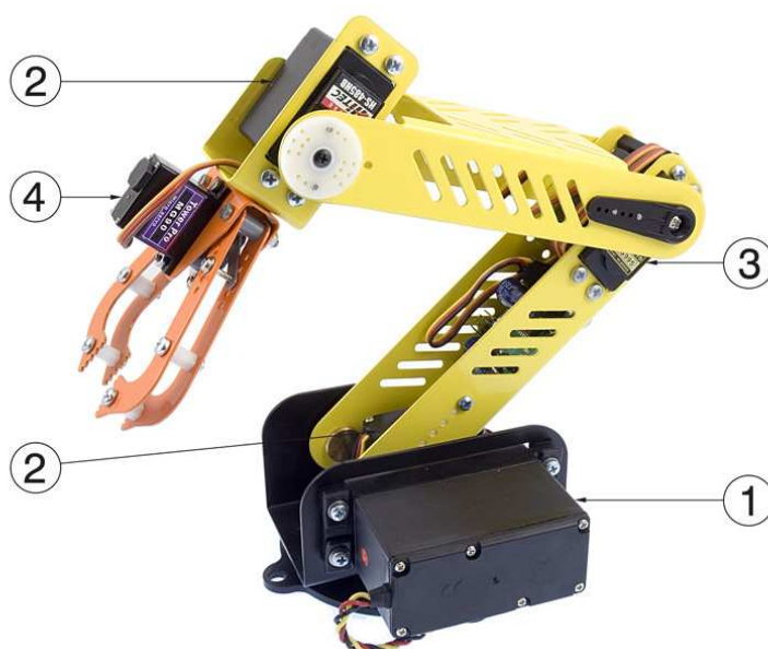
Rys. 2 Zmontowany manipulator z pokazanymi serwami.
