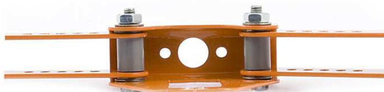
Rys. 26 Zamocowanie łapek z blaszką chwytaka.
