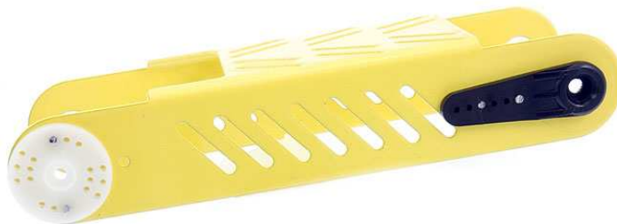
Rys. 10 Ramię 2 z przykręconymi orczykami.
