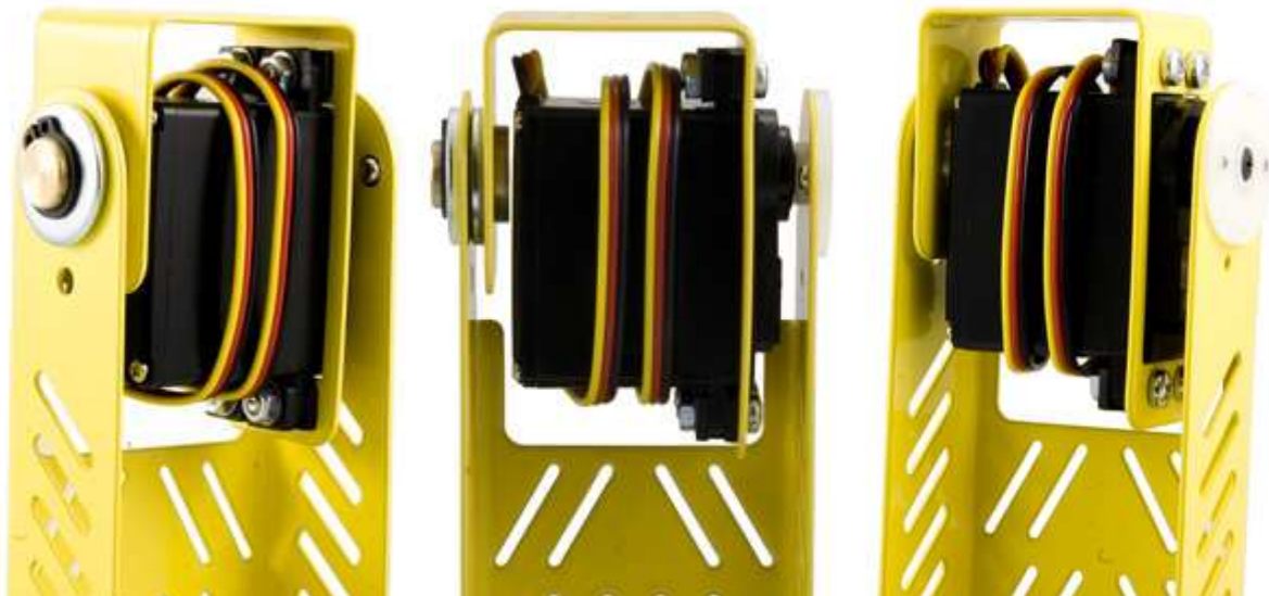
Rys. 24 Połączenie z podkładkami dystansującymi.
